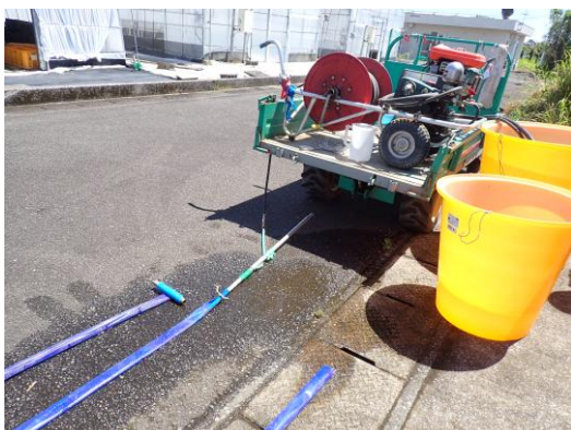
動力噴霧機などで水を押し入れる
