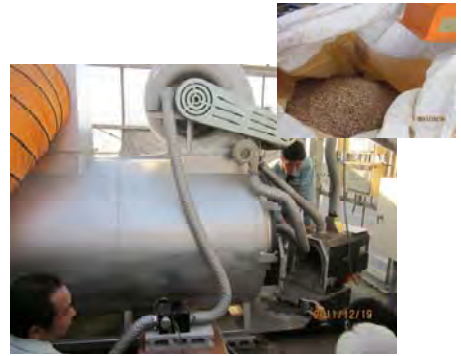
【県内産木質ペレットとコジェネシステムの試作機】
