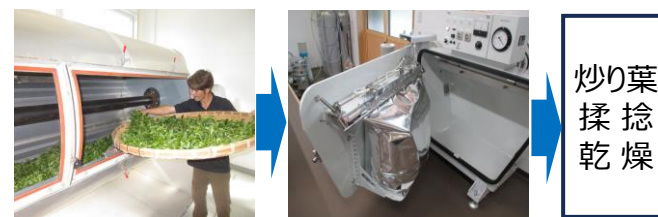
開発した萎凋機（左）での萎凋と、既存機械（中）での嫌気・好気処理による、GABA高含量烏龍茶製造法を確立
