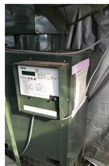
炭酸ガス発生装置 (対象：キクなど)
