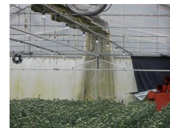
自動農薬散布装置 (対象：キクなど)
