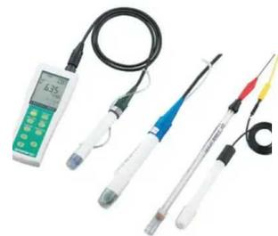
ポータブル土壌診断機器（pH・EC計）による指導
