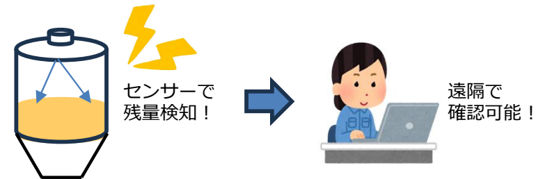
飼料残量測定装置による残量確認のデジタル化
