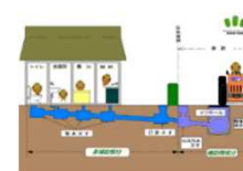
・農業集落排水施設
