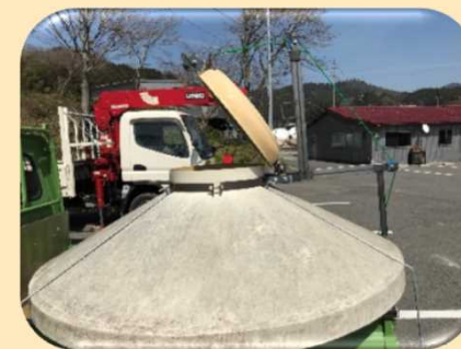
滑車式遠隔開閉タンク蓋
