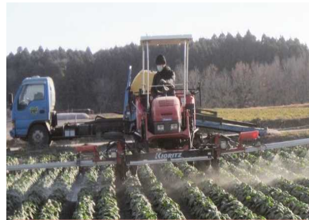
降灰除灰機による除灰作業
