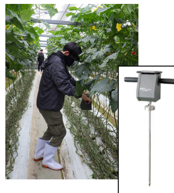
土壌硬度計を畝に貫入する様子 右横：使用した硬度計
