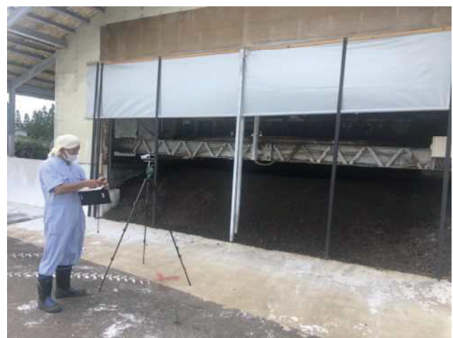
写真3 風向・風速の計測と記録
