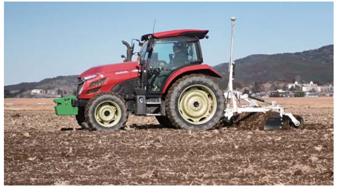
GPSレベラーによる整地
